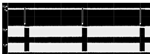
图 3 No-binning 模式 V1、H1、H2 实测波形图。 Fig. 3 Real waveform of V1, H1, H2 in no-binning mode.
